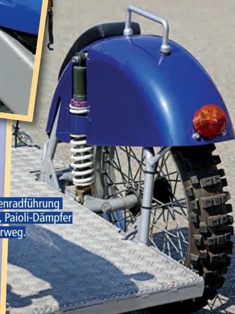
Konsequent: Seitenradführung mit Zugschwinge, Paioli-Dämpfer und langem Federweg.
