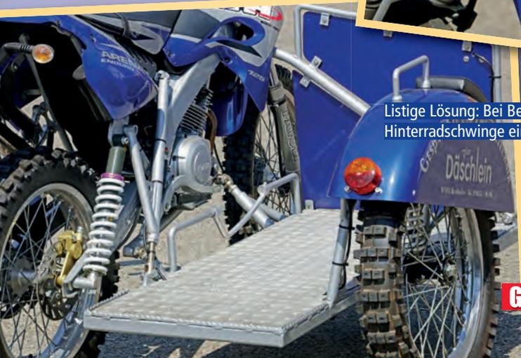
Listige Lösung: Bei Bedarf bekommt die Hinterradschwinge ein Zusatz-Federbein.
